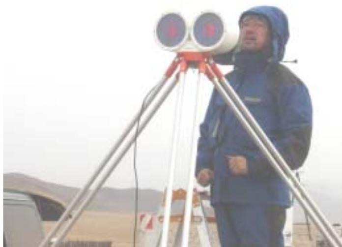
Fig. 16 The scintillometer transmitter
